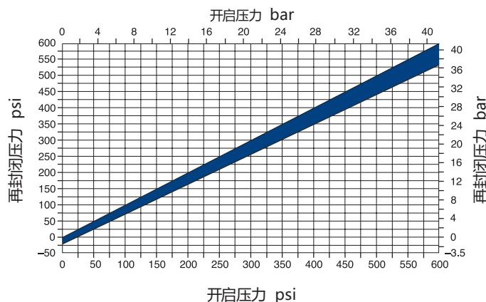
△ 单向阀有一段时间未被开启，其初始开启压力可能高于设定的开启压力。
